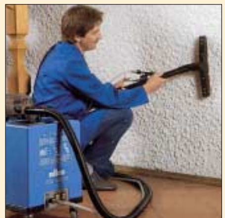
Wandwaschdüse für Reinigung von Wandplatten und Fliesen.
